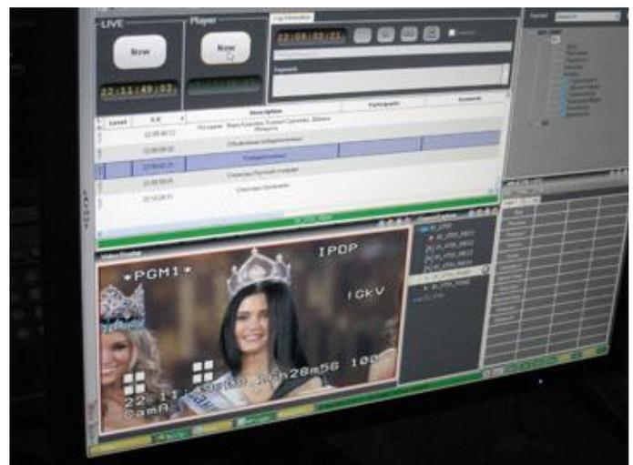
**В ПТС «Евразия» видеосервер EVS LSM-XT2 пишет и архивирует 4 канала: программный сигнал и 3 камеры.**
